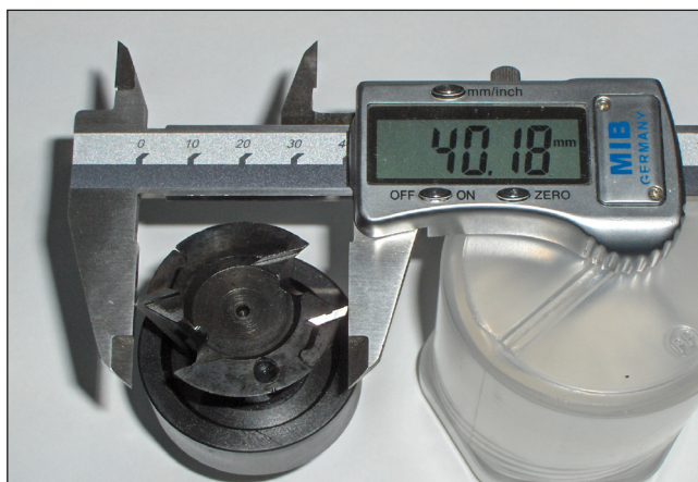
Kontrola obežnej kružnice rezania
